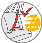
Korištenje s pojasom s tri točke u kombinaciji s konektorima Smart Fix
