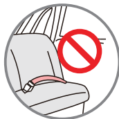
NÃO utilizar com um cinto de segurança com 2 pontos
