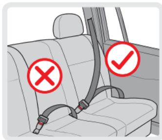
Questo seggiolino auto è adatto per l'uso tradizionale in tutti i modelli equipaggiati con cinture di sicurezza a tre punti, installate in conformità agli standard europei (ECE 44 o standard equivalenti).
