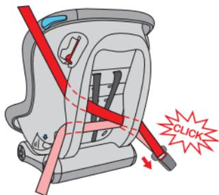
**Étape 3:** insérez la ceinture de sécurité dans le dispositif de blocage rouge et bleu (voir le point 2.8). Insérez la ceinture abdominale dans le passant (groupe 1).
