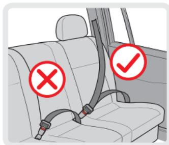
Ce siège-auto est conçu pour une utilisation normale et ne peut être installé que sur des véhicules équipés de ceintures de sécurité à trois points, conformes à la réglementation européenne (ECE 44 ou à d'autres normes équivalentes).
