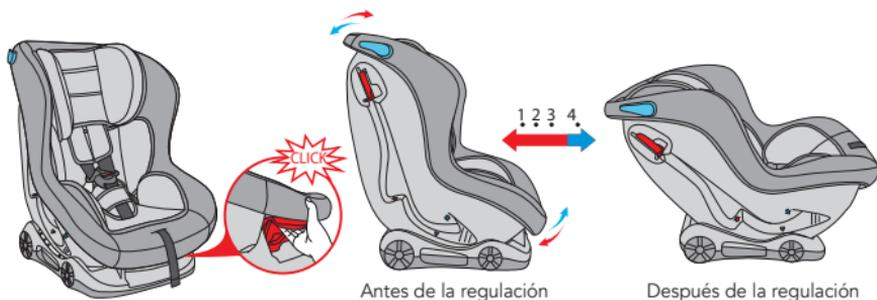
La silla de coche puede colocarse en 4 posiciones de inclinación distintas.
