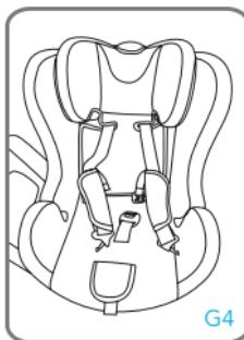
Volver a colocar la tela sobre el respaldo y el asiento. Pasar la hebilla con correa inguinal a través de la ranura del asiento. Pasar las correas de las protecciones pectorales por las ranuras de la tela del respaldo y por las ranuras de la estructura.
