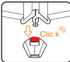
**Pour accrocher la boucle:** Faire correspondre les languettes de la boucle centrale et les insérer dans le logement de la boucle du harnais. Un « click » confirmera le verrouillage.
