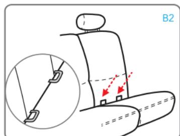
Identificar los enganches ISOFIX suministrados con el vehículo (B2). Si su coche no dispone de serie de guías para los conectores ISOFIX, introducir las guías suministradas con la silla de coche con la cavidad orientada hacia arriba en los dos puntos de anclaje ISOFIX del vehículo.
