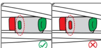
Aligner les connecteurs ISOFIX par rapport aux points d'ancrage fixés au siège du véhicule et presser jusqu'à ce qu'un « clic » se produise. Situé sur les deux étriers, l'indicateur deviendra vert,
