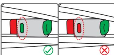
Aligner les connecteurs ISOFIX par rapport aux points d'ancrage fixés au siège du véhicule et resserrer jusqu'à ce qu'un « clic » se produise. Situé sur les deux étriers, l'indicateur deviendra vert, signalant ainsi que le produit est accroché.
