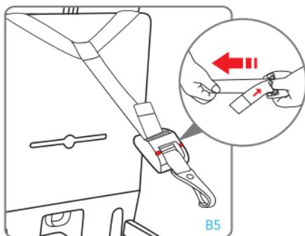
Agarrar el cinturón Top Tether y, si fuera necesario, alargar la correa presionando el correspondiente botón de bloqueo, extender la correa hasta conseguir la longitud deseada (fig. B5).
