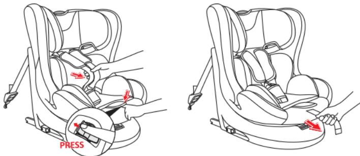
**Pour desserrer le harnais:** Appuyer sur le bouton de réglage et saisir simultanément les bretelles (ceintures pectorales) en bas, sous le rembourrage des protections pectorales et les tirer vers l'avant pour les desserrer.
