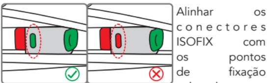
Alinhar os conectores ISOFIX com os pontos de fixação colocados no assento do veículo e pressionar até se ouvir um "clique". O indicador presente em ambos os suportes ficará verde indicando um engate correto. Verificar o engate correto de ambos os
