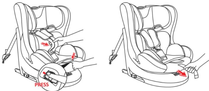
**Чтобы ослабить удерживающие ремни:** Нажмите кнопку регулировки и, одновременно с этим, возьмитесь за лямки (нагрудные ремни) в нижней части, под мягкой набивкой нагрудных накладок, потянув вперед, чтобы ослабить их натяжение.
