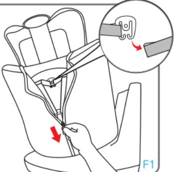
Détacher les sangles de protections pectorales du crochet (fig. F1).
