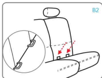
Identificar os engates ISOFIX fornecidos com o veículo (B2). Se o seu automóvel não dispuser de guias para conectores ISOFIX de série, inserir as guias fornecidas com a cadeira auto com a ranhura voltada para cima nos dois pontos de fixação ISOFIX da viatura.
