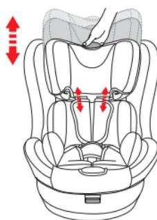
**Pour desserrer le harnais:** Appuyer sur le bouton de réglage et saisir simultanément les bretelles (ceintures pectorales) en bas, sous le rembourrage des protections pectorales et les tirer vers l'avant pour les desserrer.
