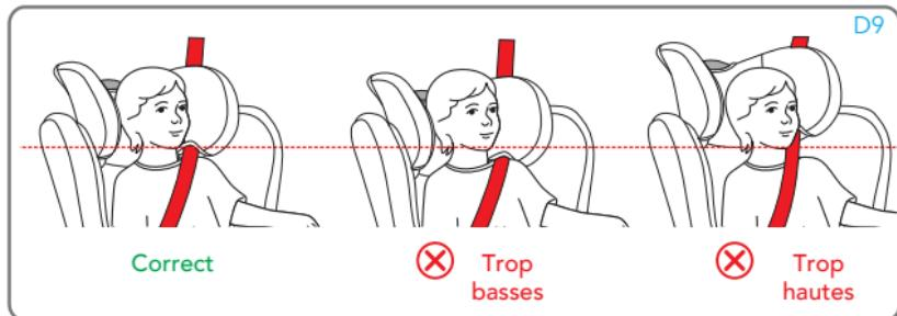
Lors de l'utilisation de la ceinture de sécurité à trois points du véhicule, l'appuie-tête doit être réglé de telle sorte qu'il y ait un espace équivalent à deux doigts entre l'appuie-tête et les épaules de l'enfant. Veiller à ce que la ceinture de sécurité pectorale, en passant par le « Passant pour la ceinture pectorale » sur le côté de l'appuie-tête, soit placée à la hauteur des épaules et non au niveau du cou de l'enfant.
