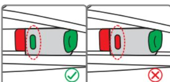
Alinhar os conectores ISOFIX com os pontos de fixação colocados no assento do veículo e pressionar até se ouvir um "clique". O indicador presente em ambos os suportes ficará verde
