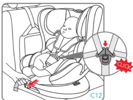
Τοποθετήστε το παιδί στο παιδικό κάθισμα αυτοκινήτου. Τοποθετήστε τους ιμάντες των ώμων πάνω από τους ώμους του παιδιού και ενώστε τις γλωσσίτσες της ζώνης και κουμπώστε τες στην πόρπη κλεισμάτος.
