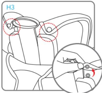
Positionner la housse de l'assise sur le siège-auto et enfiler dans la boutonnière la ceinture d'entrejambes avec protection. Repositionner avec soin la housse le long du côté, dans son emplacement. Faire attention en enfilant le tissu autour du guide de passage de la ceinture abdominale.
