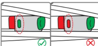
Alinee los conectores ISOFIX con los puntos de anclaje fijados en el asiento del vehículo y presione hasta escuchar un "clic". El indicador (14) presente en ambosenganches pasa al color verde para
