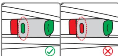
Alinhar os conectores ISOFIX com os pontos de fixação colocados no assento do veículo e pressionar até se ouvir um "clique". O indicador presente em ambos os suportes ficará verde indicando um engate correto. Verificar o engate correto de ambos os suportes. Abanar a cadeira auto para certificarse que está corretamente engatada.
