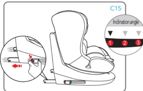
Pressionar o manipulo de regulação debaixo da parte frontal do assento da cadeira e, mantendo-o pressionado, puxar ou empurrar o assento para a frente ou para atrás. Soltar o manipulo na posição e certificar-se do correto bloqueio do assento; será ouvido um "clique" quando foi feita a fixação. O assento no Grupo 1 pode ser reclinado nas posições 1, 2 e 3.
