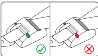
Tendre la sangle du dispositif Top Tether jusqu'à ce que l'indicateur devienne vert. Ceci indique que la sangle est correctement tendue. La sangle Top Tether doit passer au-dessus du dossier du siège du véhicule, mais jamais au-dessus de l'appuie-tête. Le cas échéant, soulever ou retirer l'appuie-tête du siège.
