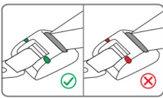
Tensar la correa del dispositivo Top Tether hasta que el indicador se vuelva verde. Esto indica que la correa está correctamente
