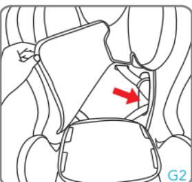
Levantar o revestimento em tecido do encosto. Fazer deslizar os cintos peitorais do compartimento esquerdo e direito. Voltar a colocar o tecido no encosto.
