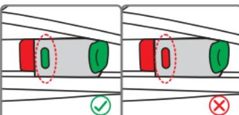
Aligner les connecteurs ISOFIX par rapport aux points d'ancrage fixés au siège
