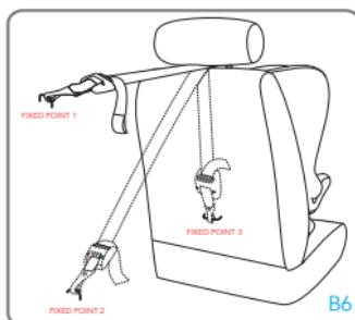
Enganchar el dispositivo superior de fijación "Top Tether" en el punto de anclaje indicado en el manual de uso del vehículo (fig. B6). Comprobar la presencia de este ícono en el interior del habitáculo.
