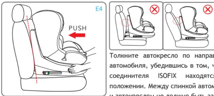
Толкните автокресло по направлению к сиденью автомобиля, убедившись в том, что оба выдвинутых соединителя ISOFIX находятся в одинаковом положении. Между спинкой автомобильного сиденья и автокреслом не должно быть зазора.
