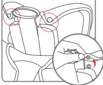
Colocar el revestimiento del asiento en la silla de coche y meter el cinturón separapiernas con protección en la ranura. Volver a colocar con cuidado el revestimiento en su sede por el lado.
