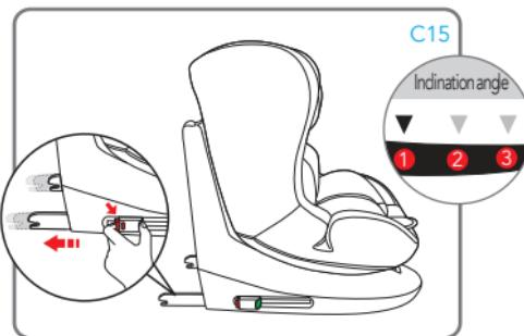
Presione la manija de regulación situada debajo de la parte frontal del asiento de la sillita y, manteniéndola presionada, tire o empuje el asiento hacia delante o hacia atrás. Suelte la manija en la posición deseada y asegúrese del bloqueo correcto del asiento; notará un "clic" cuando se enganche.
