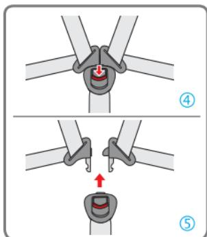
**Чтобы застегнуть пряжку:** Совместите язычки центральной пряжки (рис. 1-2) и вставьте их в специальный паз внутри пряжки удерживающего ремня (рис. 3). При правильном застегивании должен прозвучать щелчок (рис. 3).
