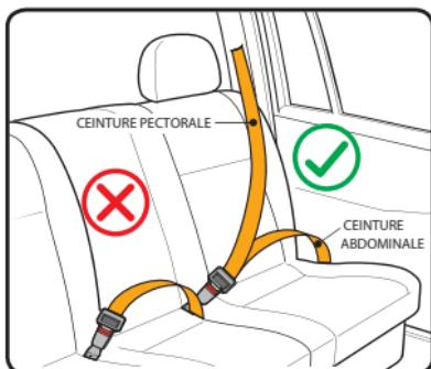
Il ne peut être installé que si les véhicules jugés adaptés sont équipés de ceintures de sécurité à 3 points, homologuées aux termes de la Réglementation ECE n°16 ou d'autres règles équivalentes.
