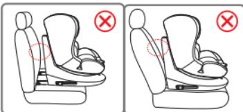
Σπρώξτε το παιδικό κάθισμα προς το κάθισμα αυτοκινήτου και βεβαιωθείτε ότι και οι δύο σύνδεσμοι ISOFIX έχουν επιμηκυνθεί μέχρι την ίδια θέση. Δεν πρέπει να υπάρχει κενό ανάμεσα στην πλάτη του καθίσματος του αυτοκινήτου και του παιδικού καθίσματος αυτοκινήτου.
