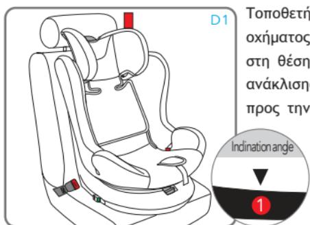
Τοποθετήστε το παιδικό κάθισμα στο κάθισμα του οχήματος. Ρυθμίστε την ανάκλιση του καθίσματος μόνο στη θέση 1. Δεν επιτρέπεται η επιλογή άλλων θέσεων ανάκλισης. Σπρώξτε το παιδικό κάθισμα αυτοκινήτου προς την πλάτη του καθίσματος του αυτοκινήτου. Δεν πρέπει να υπάρχει κενό ανάμεσα στην πλάτη του καθίσματος του αυτοκινήτου και του παιδικού καθίσματος αυτοκινήτου (D10).
