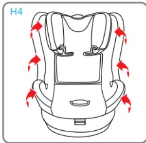
Repositionner avec soin la housse le long du bord de l'appuie-tête, dans son emplacement. Accrocher les boutons-pression de la housse de l'appuie-tête et de l'assise.
