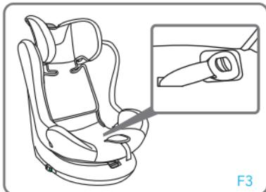
Levantar o revestimento do assento e colocar a fivela no compartimento do lado esquerdo.
