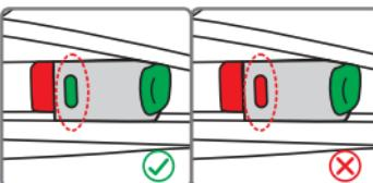
Alinee los conectores ISOFIX con los puntos de anclaje fijados en el asiento del vehículo y presione hasta escuchar un "clic". El indicador (14) presente en ambos enganches pasa al color verde para indicar que se ha realizado el acoplamiento. Comprobar que ambos enganches
