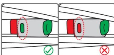
Alinee los conectores ISOFIX con los puntos de anclaje fijados en el asiento del vehículo y presione hasta escuchar un "clic". El indicador (14) presente en ambos enganches pasa al color verde para indicar que se ha realizado el acoplamiento. Menear la silla de coche para asegurarse de que esté correctamente enganchada.
