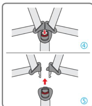
**Para enganchar la hebilla:** Hacer corresponder las lengüetas de la hebilla central (fig. 1-2) e introducirlas en su cavidad correspondiente en el interior de la hebilla del arnés. Un "clic" indicará que se ha enganchado correctamente (fig. 3).
