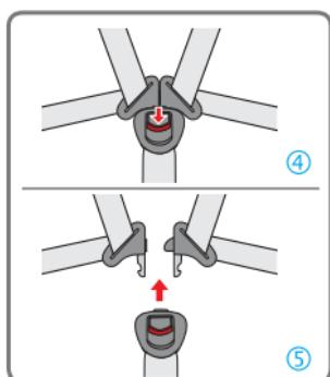
**Pour accrocher la boucle:** Faire correspondre les languettes de la boucle centrale (fig. 1-2) et les insérer dans le logement de la boucle du harnais. Un « clic » confirmera le verrouillage (fig. 3).
