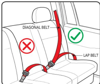
Установка разрешается лишь в том случае, если являющиеся совместимыми автомобили оснащены 3-х точечными ремнями безопасности, прошедшиими типовые испытания в соответствии с правилами ЕЭК ООН № 16 либо равнозначными нормами.
