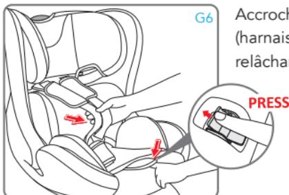
Accrocher la boucle. Vérifier que la ceinture à 5 points (harnais) est bien montée, en la tendant et en la relâchant.
