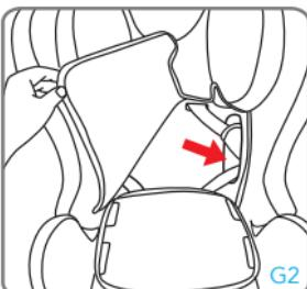
Levantar el revestimiento de tela del respaldo. Sacar los cinturones pectorales de los compartimentos derecho e izquierdo. Volver a colocar la tela sobre el respaldo.
