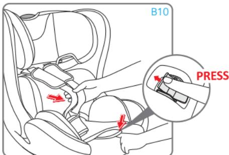
Нажмите кнопку регулировки и, одновременно с этим, возьмитесь за лямки (нагрудные ремни) в нижней части, под мягкой набивкой нагрудных накладок, потянув вперед, чтобы ослабить их натяжение.
