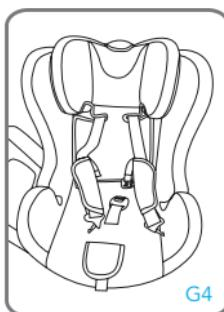
Remettre la housse en place, sur le dossier et sur l'assise. Introduire la boucle avec la ceinture de l'entre-jambes à travers la boutonnière de l'assise. Introduire les sangles des protections pectorales à travers les boutonnières de la housse du dossier et les fentes dans la coque.
