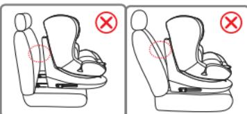
Pousser le siège-auto contre le siège du véhicule; s'assurer que les deux connecteurs ISOFIX sont étendus dans la même position. Il ne doit y avoir aucun espace entre le dossier du siège de la voiture et le siège-auto.
