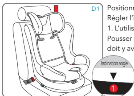
**D1** Positionnez le siège-auto sur le siège de la voiture. Régler l'inclinaison de l'assise uniquement en position 1. L'utilisation d'autres inclinaisons n'est pas autorisée. Pousser le siège-auto contre le dossier du siège. Il ne doit y avoir aucun espace entre le dossier du siège de la voiture et le siège-auto (D2).
