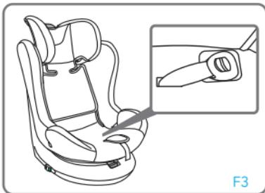
Soulever la housse de l'assise et loger la boucle dans le compartiment sur le côté gauche.
