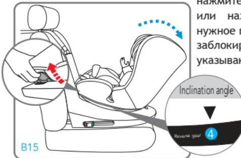
**ВНИМАНИЕ!** Если автокресло устанавливается против хода движения, сиденье должно иметь максимальный угол наклона и находиться в наиболее горизонтальном положении (4). Другой угол наклона запрещается.
