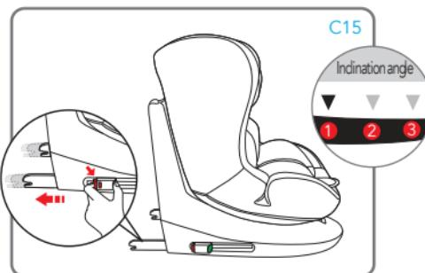
Appuyer sur le levier de réglage situé sous la partie avant du siège où se trouve le siège-auto et, tout en le maintenant enfoncé, tirer ou pousser le siège vers l'avant ou l'arrière. Relâcher le levier dans la position désirée et s'assure que le siège est bien bloqué. Le dispositif émettra un « clic » quand le verrouillage est en place Dans le Groupe 1, l'assise peut être inclinée dans les positions 1, 2 et 3.
