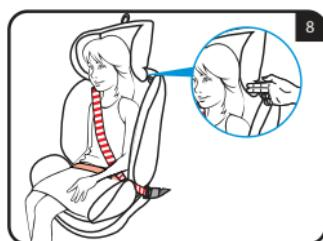
При использовании 3-х точечного ремня безопасности автомобиля подголовник необходимо отрегулировать таким образом, чтобы между ним и плечами ребенка оставалось расстояние в два пальца. Проследите за тем, чтобы нагрудный защитный ремень, пропущенный через «проушину направляющей нагрудного ремня» сбоку от подголовника, располагался на уровне плеч, а не шеи ребенка (рис. 8).
