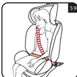
Вставьте нагрудный и поясной ремни в нижнюю проушину, рядом с пряжкой застегивания ремня безопасности автомобиля (рис. 59).
