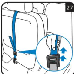
Esticar o cinto Top Tether, puxar a correia afrouxada a partir da extremidade livre até que esta fique suficientemente esticada. Um indicador previsto para o efeito no regulador, passando para a cor verde, indicará a tensão correta do cinto (fig. 27).
