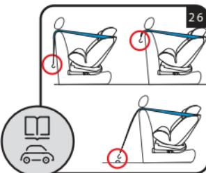
Apertar o cinto Top Tether e, se necessário, alongar a correia pressionando o botão de bloqueio previsto para o efeito e esticar a correia até ao comprimento desejado (fig. 25).
