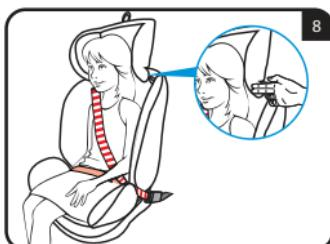
Quando si utilizza la cintura di sicurezza a 3 punti del veicolo, il poggiatesta deve essere regolato in modo che vi sia uno spazio di due dita tra il poggiatesta e le spalle del bambino. Assicurarsi che la cintura di sicurezza pettorale, passando nel "passante guida cintura pettorale" a lato del poggiatesta, sia posizionata all'altezza delle spalle e non del collo del bambino (fig. 8).
