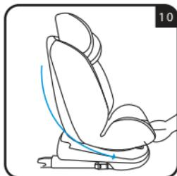
Appuyer sur le levier de réglage situé sous la partie avant du siège où se trouve le siège-auto et, tout en le maintenant enfoncé, tirer ou pousser le siège vers l'avant ou l'arrière. Relâcher le levier dans la position désirée et s'assure que le siège est bien bloqué. Le dispositif émettra un « clic » quand le verrouillage est en place (fig. 10).
