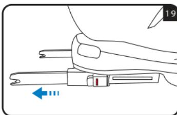
Appuyer sur les boutons ISOFIX présents sur les deux côtés du siège et étendre au maximum les connecteurs ISOFIX (fig. 18 e 19).
