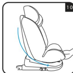
Pressionar o manipulo de regulação debaixo da parte frontal do assento da cadeira e, mantendo-o pressionado, puxar ou empurrar o assento para a frente ou para trás. Soltar o manipulo na posição e certificar-se do correto bloqueio do assento; será ouvido um "clique" quando foi feita a fixação (fig. 10).
