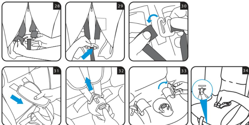
Desenganchar las correas de los cinturones pectorales del enganche del tensor del cinturón en la parte posterior de la silla de coche (fig. 28)
