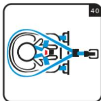
Povucite remen s vrha remena uz obje strane sjedala i pričvrstite pojas na „kuku“ na odgovarajuću točku sidrenja (vidi točku 4.7) (sl. 39). Stavite dijete u autosjedalicu. Podesite naslon za glavu na odgovarajuću visinu (vidi paragraf 4.3), ispravno postavite remenje i pričvrstite kopču (vidi par. 4.1), i na kraju zategnite remenje (vidi par. 4.2) (sl. 40).
