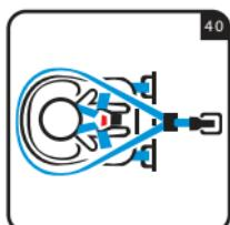
Faire glisser la ceinture Top Tether le long des deux côtés du siège-auto et attacher le « crochet » de la ceinture au point d'ancrage prévu à cet effet (voir paragraphe 4.7). (fig. 39). Placer l'enfant dans le siège-auto. Réglér l'appuie-tête à la hauteur appropriée (voir paragraphe 4.3), positionner correctement le harnais et fixer la boucle (voir paragraphe 4.1), puis serrer le harnais (voir paragraphe 4.2) (fig. 40).
