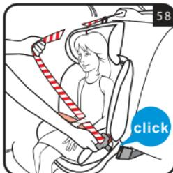
Τοποθετήστε το παιδί στο παιδικό κάθισμα αυτοκινήτου. Ρυθμίστε το προσκέφαλο στο κατάλληλο ύψος (βλ. παρ. 4.3). Τραβήξτε τη ζώνη ασφαλείας του οχήματος και περνώντας την μπροστά από το παιδί, ασφαλίστε την πόρπη της ζώνης ασφαλείας του οχήματος και τοποθετήστε το άκρο στο κούμπωμα της πόρπης (εικ. 58). Ένα κλικ θα σας δηλώσει το κλείδωμα στη σωστή θέση. ΠΡΟΣΟΧΗ! Η πόρπη της ζώνης ασφαλείας του οχήματος δεν πρέπει να τοποθετηθεί στον κάτω οδηγό της διόδου του ιμάντα της κοιλιάς
