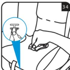
Otkačite trake prsnog pojasa s nosača zatezača pojasa na stražnjem dijelu automobilskog sjedala (sl. 28)
