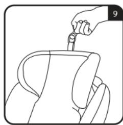
**Para levantar o apoio da cabeça:** puxar para cima a correia de regulagem do apoio da cabeça.
