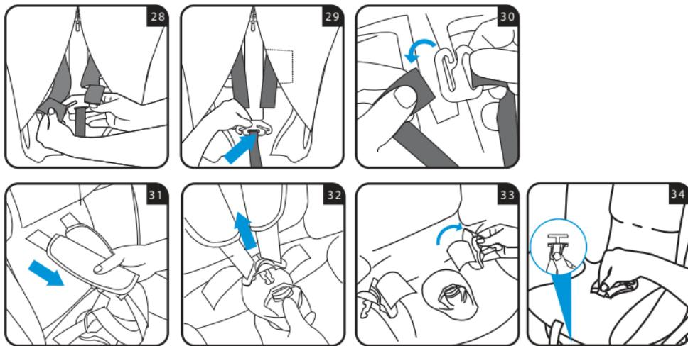
Отстегните нагрудные ремни от скобы-натяжителя ремней, расположенной в задней части автокресла (рис. 28).
