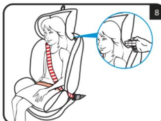
Cuando se utiliza el cinturón de seguridad de 3 puntos del vehículo, el apoyacabezas debe regularse de forma que haya un espacio de dos dedos entre el apoyacabezas y los hombros del niño. Asegurarse de que el cinturón de seguridad pectoral, al pasar por la "guía del cinturón pectoral" en el lateral del apoyacabezas, quede situado a la altura de los hombros y no del cuello del niño (fig. 8).
