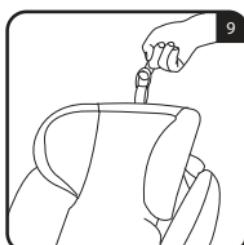
**Para levantar el apoyacabezas:** tirar hacia arriba de la correa de regulación del apoyacabezas.
