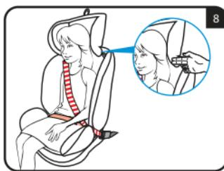
Lors de l'utilisation de la ceinture de sécurité à trois points du véhicule, l'appuie-tête doit être réglé de telle sorte qu'il y ait un espace équivalant à deux doigts entre l'appuie-tête et les épaules de l'enfant. Veiller à ce que la ceinture de sécurité pectorale, en passant par le « Passant pour la ceinture pectorale » sur le côté de l'appuie-tête, soit placée à la hauteur des épaules et non au niveau du cou de l'enfant (fig. 8).
