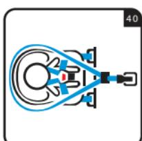
Σύρετε τον ιμάντα Top Tether κατά μήκος των δύο πλευρών του παιδικού καθίσματος, και ασφαλίστε το «άγκιστρο» της ζώνης στο κατάλληλο σημείο ασφάλισης (βλ. παρ. 4.7) (εικ. 39). Τοποθετήστε το παιδί στο παιδικό κάθισμα αυτοκινήτου. Ρυθμίστε το προσκέφαλο στο κατάλληλο ύψος (βλ. παρ. 4.3), τοποθετήστε σωστά τη ζώνη και στερεώστε το κούμπωμα (βλ. παρ.4.1) και τέλος τεντώστε τη ζώνη (βλ. παρ. 4.2) (εικ. 40).
