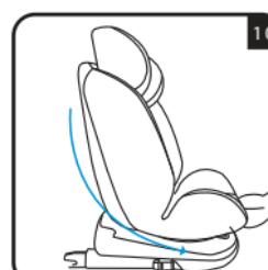
Presione la manija de regulación situada debajo de la parte frontal del asiento de la sillita y, manteniéndola presionada, tire o empuje el asiento hacia delante o hacia atrás. Suelte la manija en la posición deseada y asegúrese del bloqueo correcto del asiento; notará un "clic" cuando se enganche (fig. 10).
