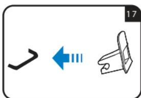
Se la vostra auto non dispone di guide per connettori ISOFIX di serie, inserire le guide fornite in dotazione con il seggiolino auto con l'incavo rivolto verso l'alto nei due punti di ancoraggio ISOFIX della vettura.
