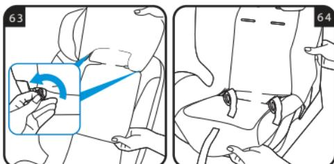
**Para remover o revestimento:** Remover primeiro o arnês (cf. par. 4.8) e a seguir o revestimento (fig. 63 e 64).
