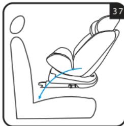
Rodar a cadeira auto até que esta fique voltada no sentido contrário ao da marcha (cf. par. 4.5) e de seguida inclinar o assento na posição mais horizontal (cf. par. 4.4). Colocar o assento de modo a que fique voltado no sentido contrário ao da marcha (fig. 35, 36 e 37). Utilizar o redutor com crianças com peso inferior aos 9 kg.
