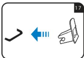
Si su coche no dispone de serie de guías para los conectores ISOFIX, introducir las guías suministradas con la silla de coche con la cavidad orientada hacia arriba en los dos puntos de anclaje ISOFIX del vehículo.
