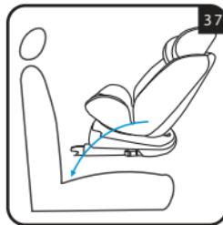
Ruotare il seggiolino fino a rivolgerlo in senso contrario alla direzione di marcia (cfr. par. 4.5), quindi inclinare la seduta nella posizione più orizzontale (cfr. par. 4.4). Posizionare la seduta in modo che sia rivolta in senso contrario alla direzione di marcia (fig. 35, 36 e 37). **Utilizzare il riduttore con bambini di peso inferiore ai 9 kg.**
