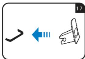
Si le véhicule n'est pas équipé de guides de fixation ISOFIX de série, introduire les guides fournis avec le siège-auto avec la fente tournée vers le haut, dans les deux points d'ancrage ISOFIX du véhicule.
